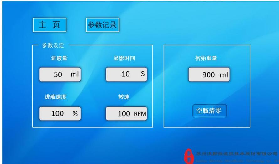
(1) “空瓶清零”：空瓶时点击，重量清零（注：为了提高进液精度，可以在空瓶时，点击清零，其他时间不需要点击清零）。
