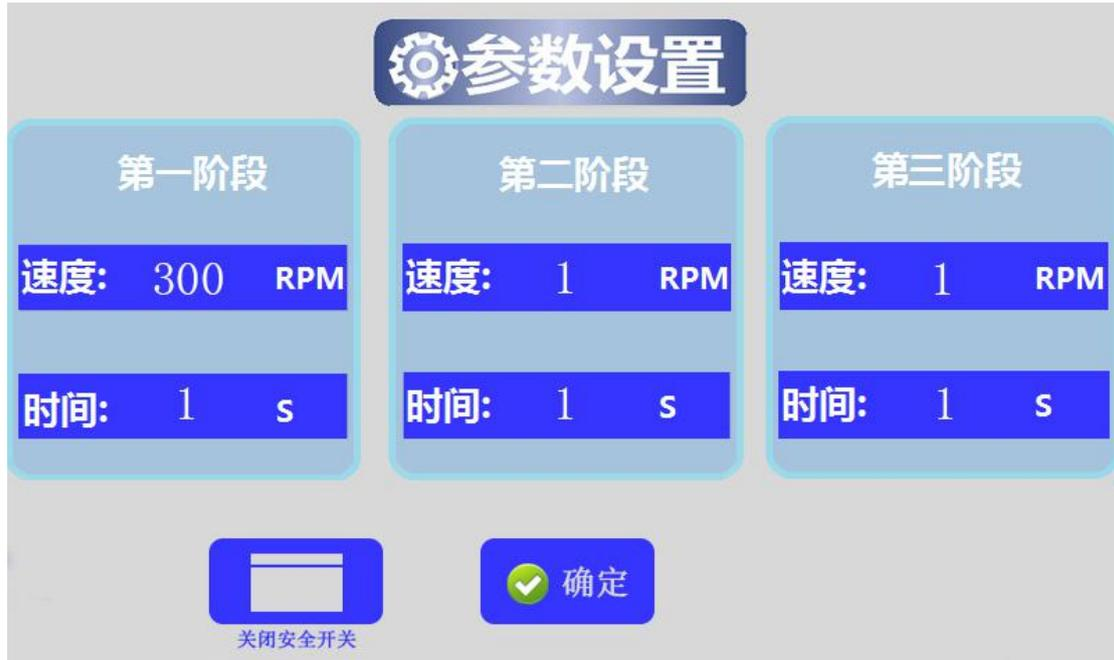
(3) 进入启动仪器界面，放片，要注意放正。滴胶，关上上盖，安全开关启动；打开真空泵，点击“吸盘”后点“启动”，仪器开始运行。转速和运行阶段以及当前阶段剩余时间可在显示屏上实时观察。
