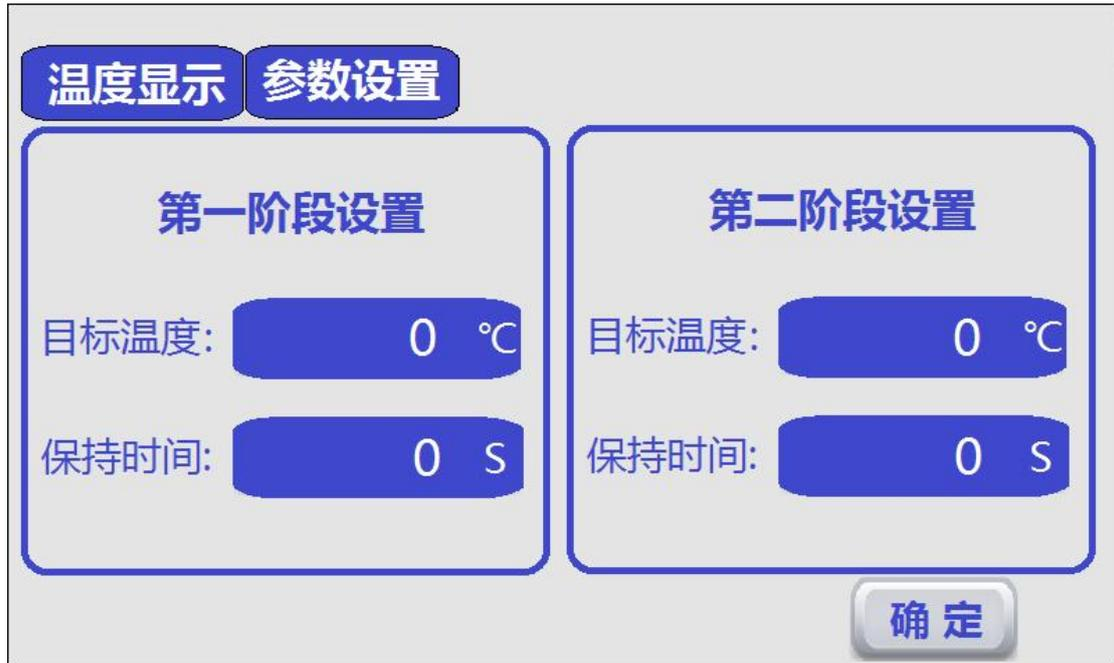
(3) 启动运行：点击触摸屏进入温度显示界面，点击启动，此时烘箱开始按设定温度升温，并能观测温度实时曲线，当前温度与目标温度相差 1°C 时，烘箱开始计算阶段温度剩余时间。
